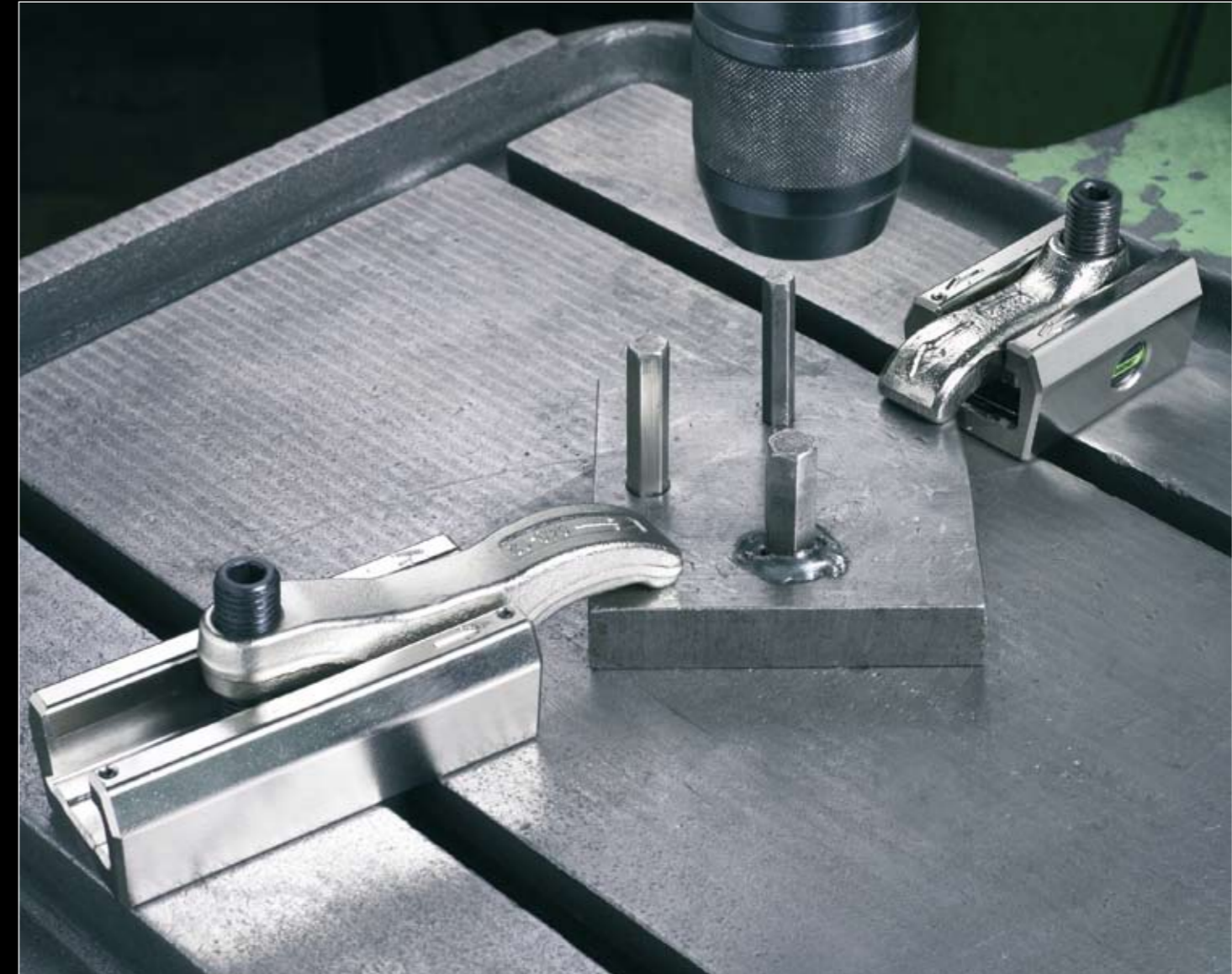
Aufnahmevorrichtung mit MQ60 oder MQ70 auf Bohrmaschine fixiert
