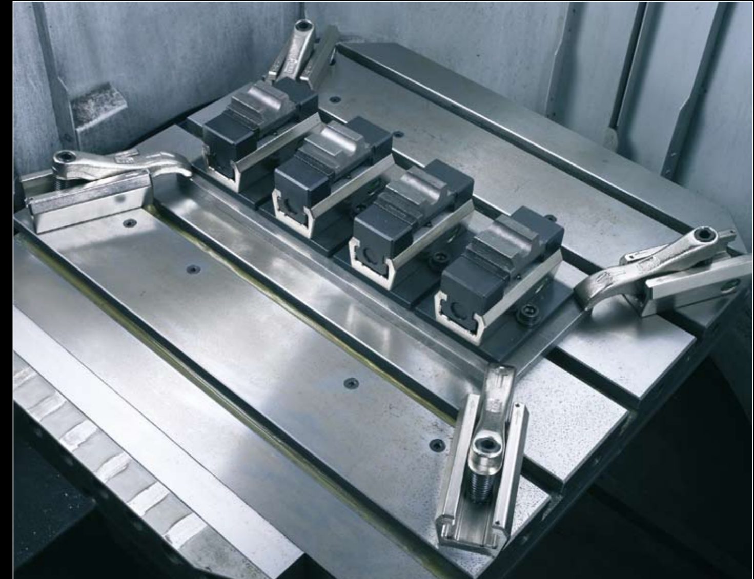
Fertigung von Spannbacken mit Zentrierspanner gespannt und mit MQ60 fixiert
