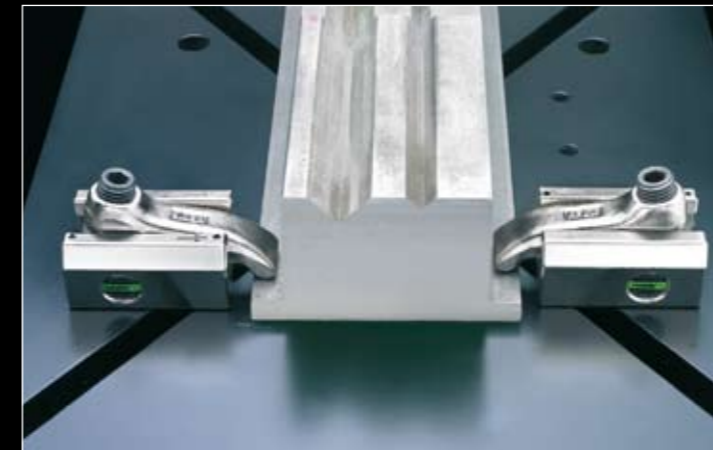
Abkantwerkzeug auf Stanze mit MQ60 fixiert
