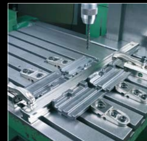
Spannschuhhälften mit Flachspanner FL10 gespannt
