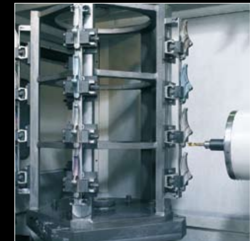
Serienfertigung für Spannhebel MQ100 auf Sonderwürfel mit Zentrierspanner gespannt
