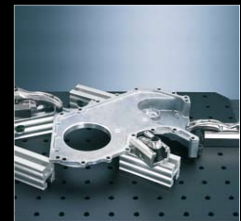
Gehäusedeckel mit B50 unterstützt, mit MQ Spannelementen fixiert und gespannt
