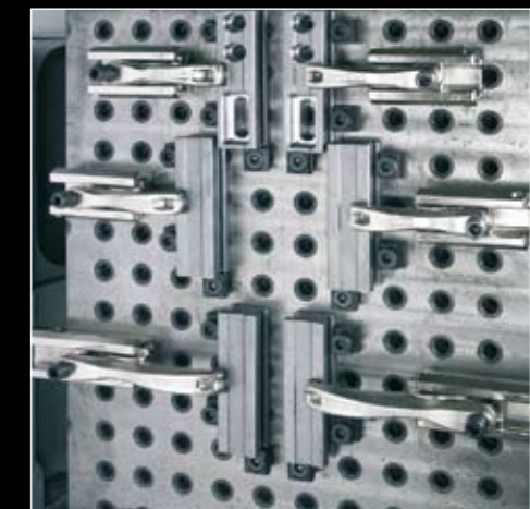
Serienanfertigung für Aufspannleiste MQ160 auf Spannwürfel mit MQ100 gespannt
