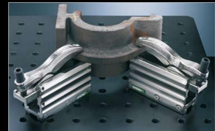
Gehäuseschale auf Spanschuh mit MQ200 gespannt
