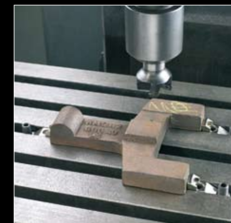
Gabel mit Nutenspanner gespannt
