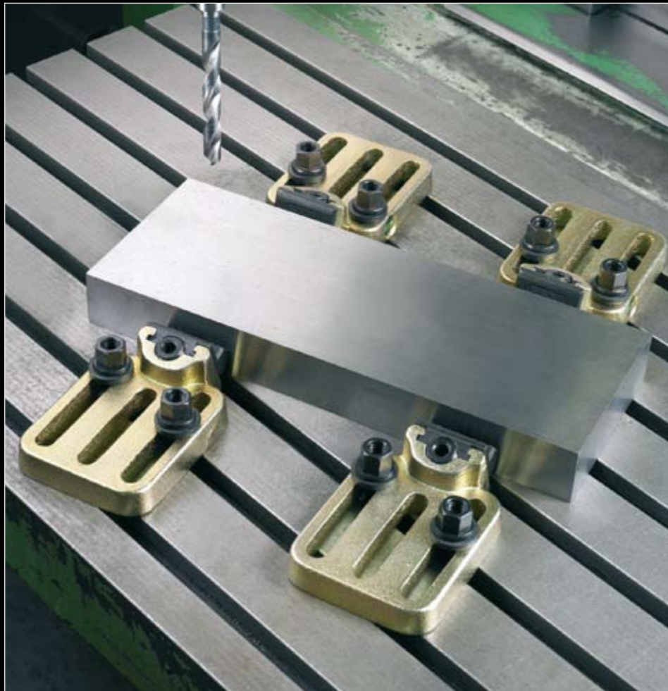
Plattenbearbeitung für freie Oberfläche mit SKQ10 gespannt
