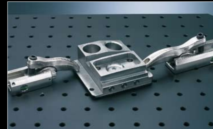
Ventilkörper mit MQ100 gespannt
