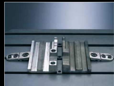
Flachspanner FL10 im Einsatz auf Fräsmaschine
