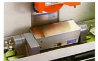
サインバー式マグネットチャック 幅×奥行(300×110) Magnetic chuck with sin bar
