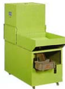
吸塵給水装置 (マグネットセパレータ付) 幅×奥行×高さ(540×1300×1300) 使用モータ 40W(給水用) 0.4kW(吸塵用) 25W(セパレータ用) 吸塵能力 50/60Hz、9.0/10.8m 3 /min ポンプ能力 50/60Hz、19/25Q/min マグネットセパレータ能力 20Q/min タンク容量 100Q Dust collector/Coolant device with magnetic separator
