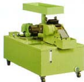
給水装置 (マグネットセパレータ付) 幅×奥行×高さ(500×1020×720) 使用モータ 40W(給水用) 25W(セパレータ用) ポンプ能力 50/60Hz、19/25Q/min マグネットセパレータ能力 20Q/min タンク容量 100Q Coolant device with magnetic separator
