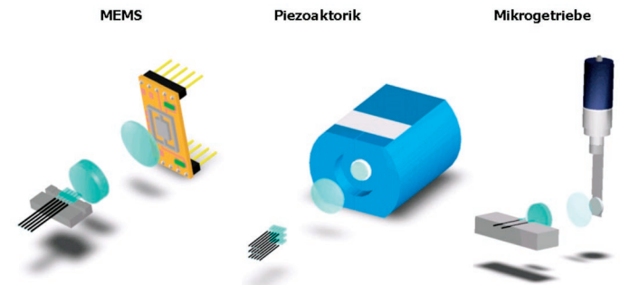
Bild 6: Drei mögliche Aktorkonzepte für eine Spiegelkippen (Quelle: Pyramid Optics GmbH; Lederhose)
