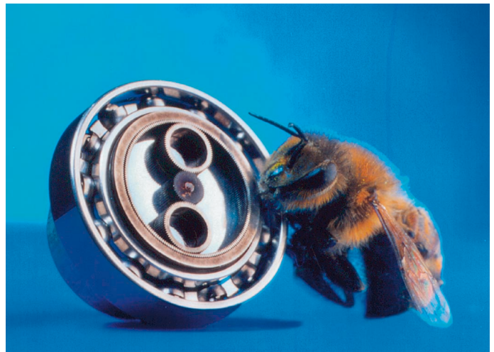
Bild 1: Der hier im Größenvergleich mit einer Biene gezeigte Getriebeeinbausetz Micro Harmonic Drive bietet ein Drehmoment von 30 mNm bei einem Außendurchmesser von nur 8 mm und einer axialen Länge von 1 mm.
