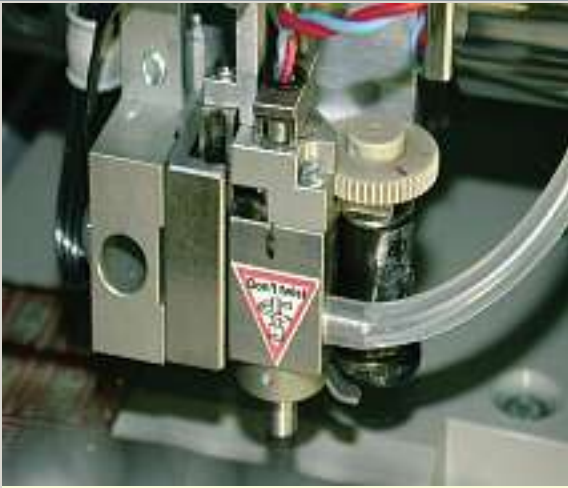
Neuartiges „Rotary Bond Tool“, um bei der Halbleiterfertigung Chips mit extrem hoher Genauigkeit in beliebige Winkelposition zu positionieren. Quelle: Alphasem AG, Schweiz
