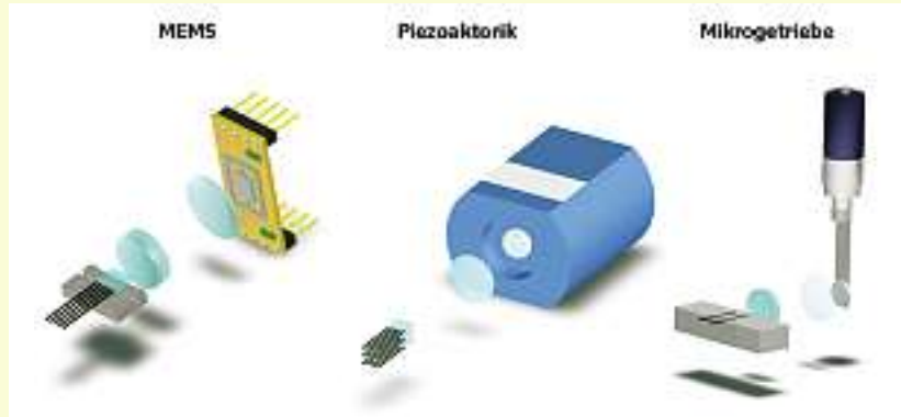
und drei mögliche Aktorkonzepte für eine Spiegelklippung. Quelle: Pyramid Optics GmbH (MEMS = Micro Electro Mechanical System)
