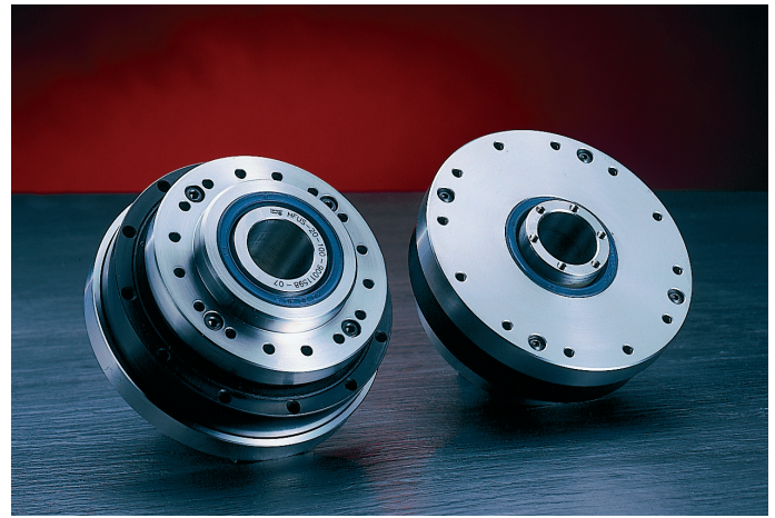
3: Hohlwellengetriebe des Typs HFUS-2UH mit kippsteifem Kreuzrollenabtriebslager
