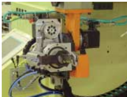
2: Der Servoantrieb ist Bestandteil einer Drahtwickelmaschine der Firma Statomat
