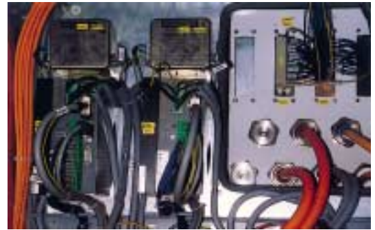
Bild 3: HA-400-Regelgeräte zum Betrieb der Teiltische
