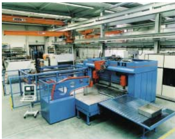
2: Im Biegezentrum B12 von Weinbrenner haben elektromechanische Antriebe in Form von Präzisionsgetrieben mit AC-Servomotoren die hydraulischen Positionierantriebe ersetzt
