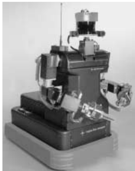
10: Multifunktionsroboter mit Präzisionsgetriebe Werkbild Daimler-Chrysler Raumfahrt Infrastruktur
