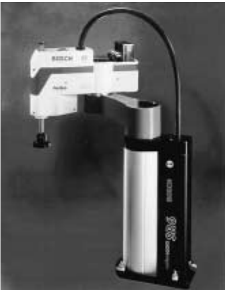
9: Schwenkarmroboter-Roboter mit Präzisionsgetriebe Werkbild Robert Bosch GmbH
