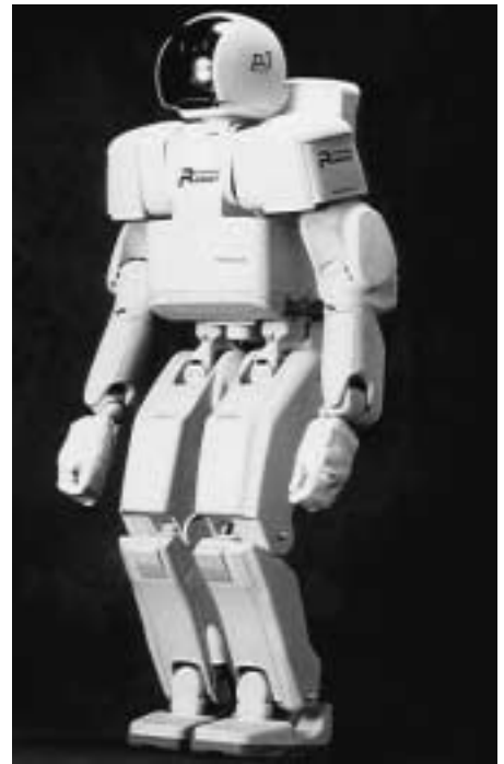
11: Humanoidroboter mit Präzisionsgetrieben Werkbild Honda Engineering
