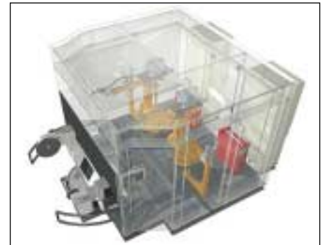
3: Innenansicht der Schweißanlage Quelle: Robolution
