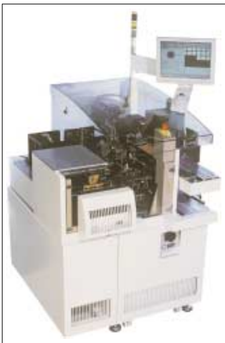
7: „die attach“-Maschine vom Typ Easyline 8032 von Alphasem
