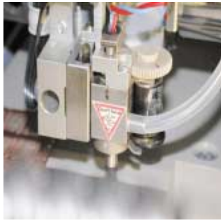
8: Die „rotary bond tool“-Baugruppe positioniert mit dem Micro Harmonic Drive-Getriebe Chips hochpräzise Quelle: Alphasem AG
