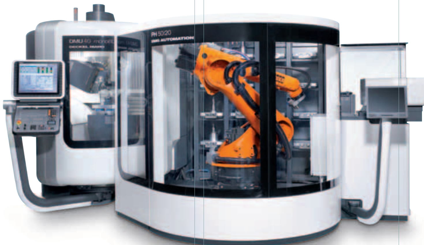
Automationslösungen für die monoBLOCK®-Baureihe: z. B. DMU 40 monoBLOCK® mit automatischem Be- und Entladesystem mit 6-Achsen-Roboter und Pa- letten-Handling, Palettengewicht bis 50 kg, 20 Plätze.
