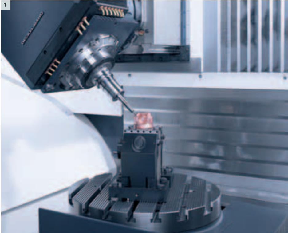
I1| Großer Arbeitsraum mit integriertem NC-Rundtisch und NC-gesteuertem Fräskopf (optional, Standard bei DMU 40)
