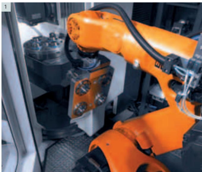
1+2| Automatisches Paletten-Handling, Palettenspeicher mit 20 Plätzen
