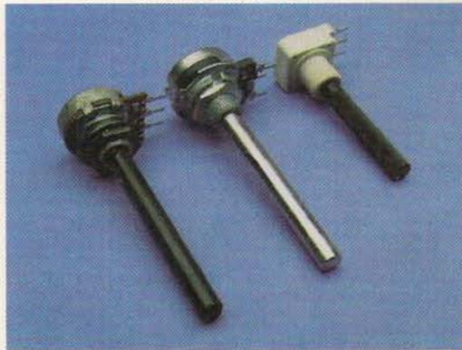
A potenciométerek – a beállító ellenállásokhoz (trimmer) hasonlóan – két meghatározott szélső érték között szabályozhatók
