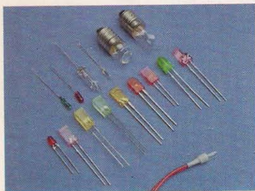
A modellekben fényforrásnak izzókat, vagy fénykibocsátó diódákat (LED) használnak. Mindkettő igen sokféle kivitelben kapható
