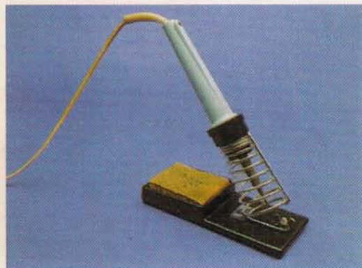
A munkákhoz nélkülözhetetlen a pákatartó, amelyen helye van a nedves szivacsnak. A forró csúcsot a nedves szivacson kell letisztítani
