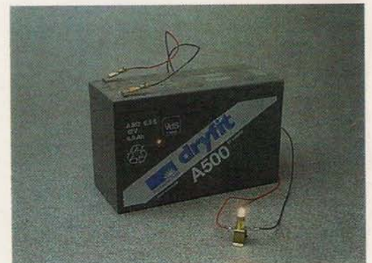
Az egyszerű áramkör áramforrásból (pl. akkumulátorból), szigetelt vezetékekből és fogyasztóból (pl. izzóból) áll
