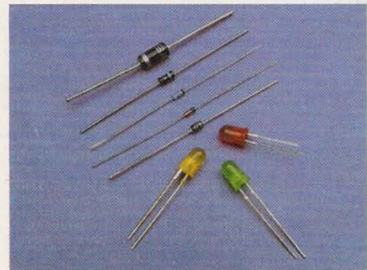
A diódákat általában henger formájú tokba építik be. A katód kivezetését színes gyűrűvel jelölik
