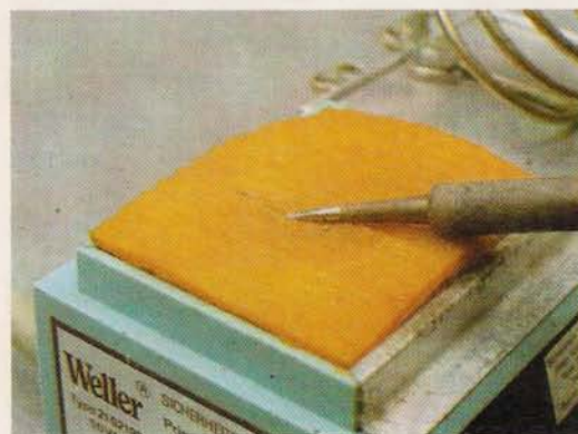
Minden forrasztás előtt a nedves szivacson kell tisztára törölni a forró pákacsúcsot
