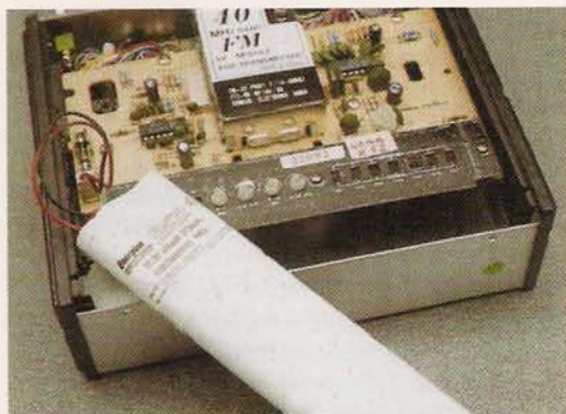
Az adókat a hosszú üzemeltetés érdekében csak tartós, nagy kapacitású akkumulátorokkal használjuk
