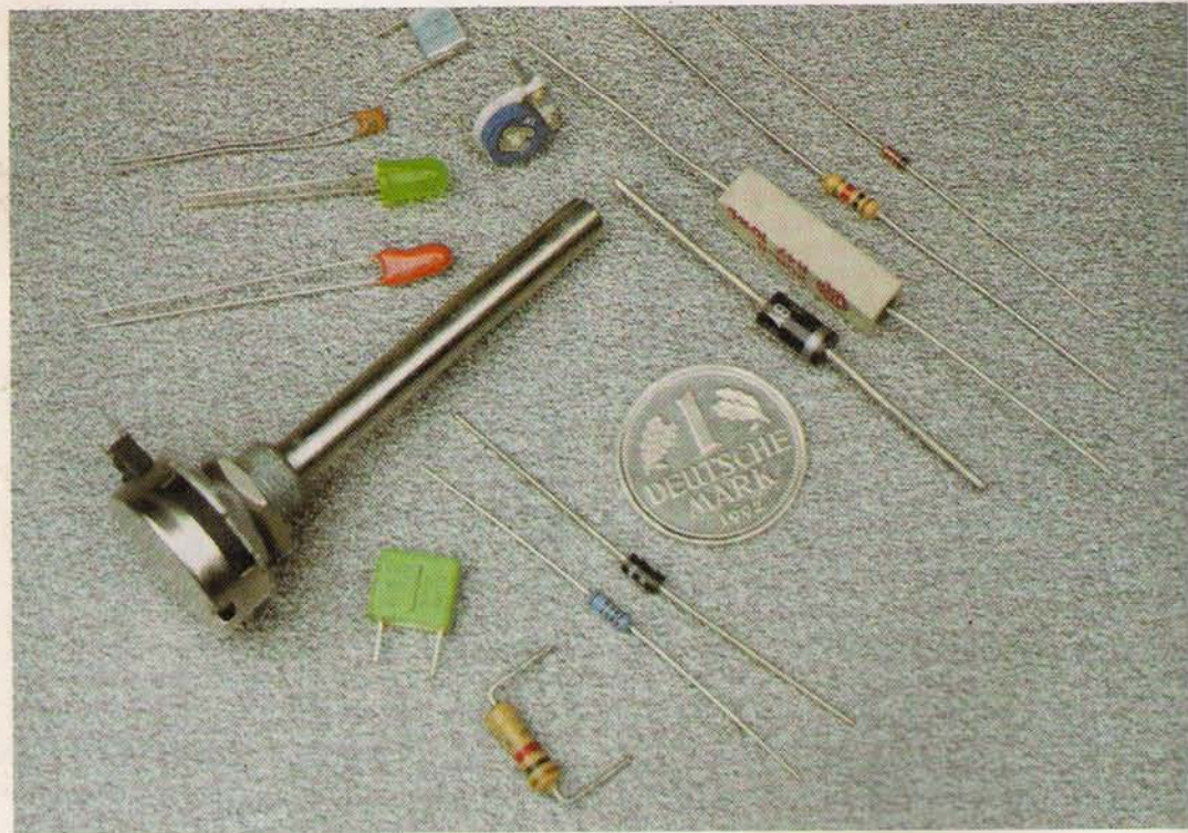
Az ábrán látható „hagyományos” alkatrészek eléggé terjedelmesek, de a kezdők számára különösen alkalmasak egy elektronikus áramkör összeállítására
