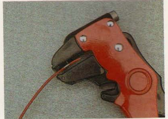
A műanyag szigetelés eltávolítására egy speciális csupaszító fogó a legalkalmasabb
