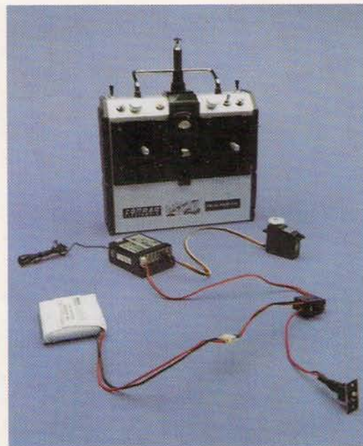
A távvezérlő berendezés első működtetési próbája. Egy ilyen ideiglenes elrendezéssel egyes részegységek (pl. szervó) működését összeépítés előtt lehet ellenőrizni
