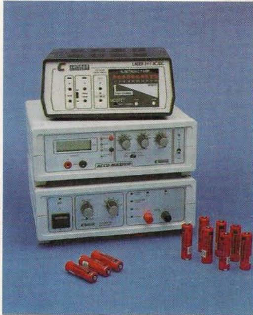
Az akkumulátortöltők különböző kivitelben és árban kaphatók. Kiválasztásnál fő szempont, hogy legyen beépített töltést szabályozó automatikája, mert ez jelentősen meghosszabbíthatja az akkumulátorok élettartalmát
