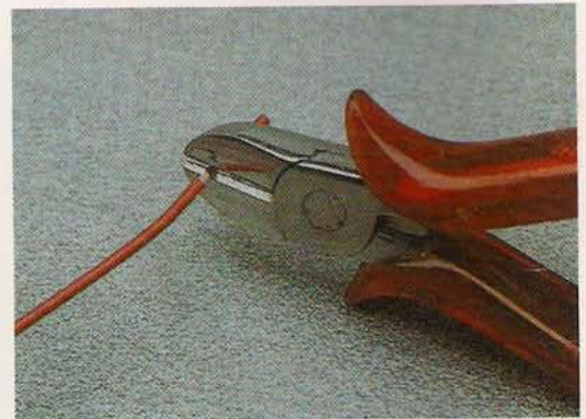
Kellő gyakorlattal oldalcsípő fogót is használhatunk a műanyag szigetelés eltávolítására
