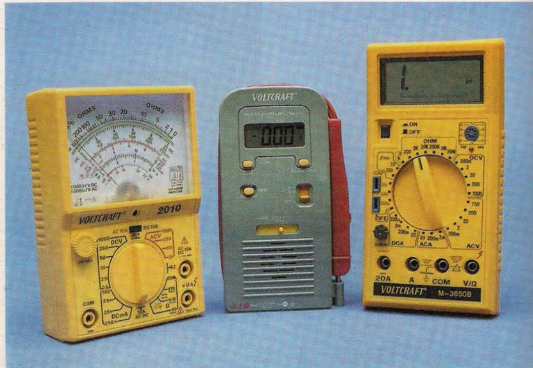
A képen különféle analóg, vagy digitális kijelzőkkel ellátott univerzális kézi mérőműszerek láthatók. Amatőr méréseknél mindegyik jól használható
