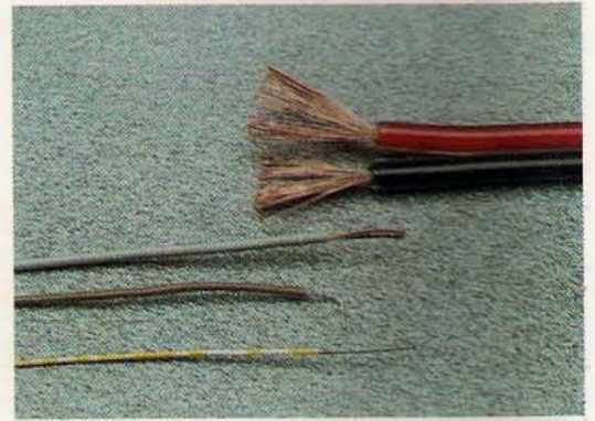
A modellépítésben kizárólag a hajlékony, sodrott erű rézvezetékek használatosak. Az erek igen sok vékony elemi részből állnak, műanyag szigeteléssel burkoltak
