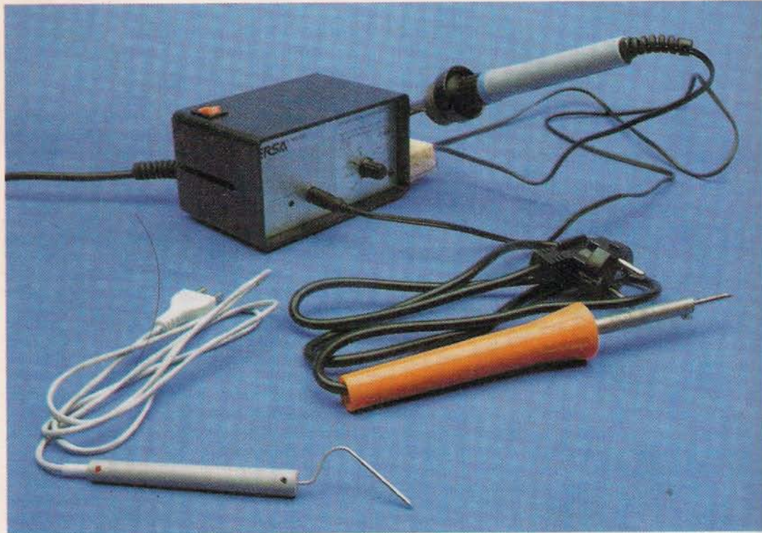
A forrasztási munkák nélkülözhetetlen eszköze a forrasztópáka, a legjobb, ha hőszabályozós. A finom munkákhoz igen kis méretű forrasztóeszközt kell használni
