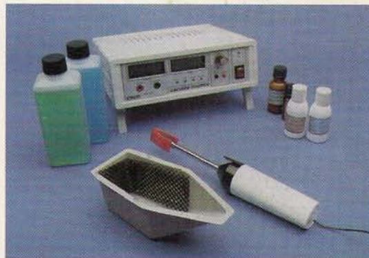
A képen látható, vagy ezekhez hasonló eszközökkel bárki végezhet felületnemesítést galvanizálással. A nemes fémbevonat nagyban növeli az alkatrészek használati értékét
