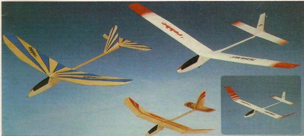
A repülőmodellezésnél fő a fokozatosság. Ilyen vagy hasonló gyakorlógépek megépítésével és repítésével lehet megszerezni a motoros gépekhez szükséges modellezői rutint
