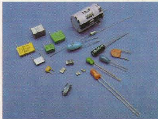
A kondenzátorok igen sokféle méretben és alakban készülnek, főbb műszaki adataik külső burkolatukon találhatóak
