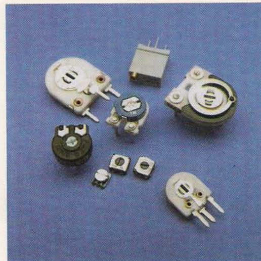
A különféle kapcsolásokban az alapértékeket kiegyenlítő ellenállással (trimmer) lehet beállítani
