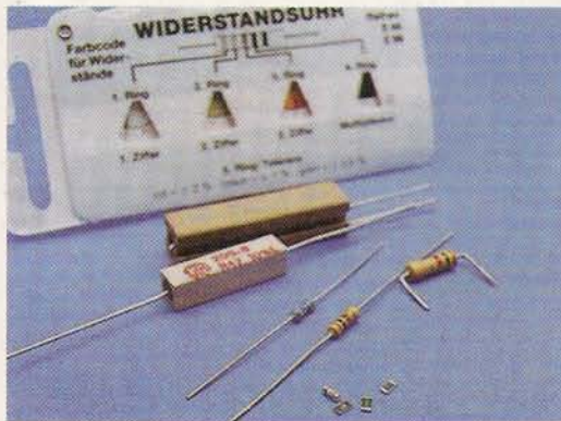
A terhelhetőségük miatt jelentős méretkülönbségű ellenállások vannak. Az előtérben parányi SMD-ellenállások láthatók
