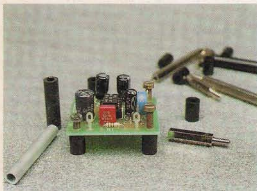
A burkolat nélkül felépített kapcsolást célszerű szigetelt lábakra szerelni és ezzel is védeni
