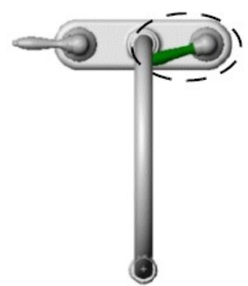
Ütközés vizsgálat, a Megállítás ütközésnél aktív. Figyelje meg, hogy a fogantyú nem tud áthaladni a kifolyóban.
