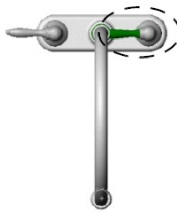
Ütközés vizsgálat, a Megállítás ütközésnél ki van kapcsolva. Figyelje meg, hogy a fogantyú a kifolyóban van.
